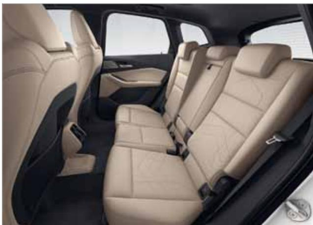
□ Díky širokým možnostem nastavení zadních sedadel lze prostor vzadu a zavazadlový prostor využívat mnohem flexibilněji. Sedadla rozdelená v poměru 60:40 lze individuálně posunovat v rozsahu 130 mm.
