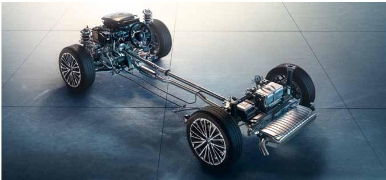
□ Adoptivní M podvozek<sup>1</sup> je o 15 milimetrů snížený a lze jej kdykoliv elektronicky nastavit tak, aby odpovídalo stavu vozovky a jízdnímu stylu řidiče. Výsledkem je zlepšená jízdní dynamika s vynikající přilnavostí k vozovce a zároveň vysoká úroveň jízdního komfortu a lepší schopnosti jízdy na dlouhé vzdálenosti. Exkluzivní M sportovní řízení přináší pocit z řízení.
