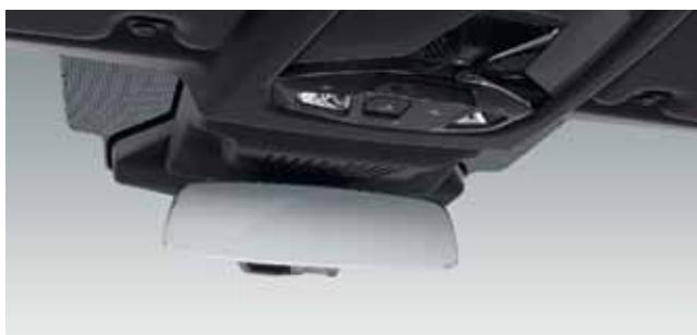
□ Paket vnitřních a vnějších zpětných zrcátek obsahuje automatické zatmavování vnitřního a vnějšího zpětného zrcátka na straně řidiče a elektrické sklápění vnějších zpětných zrcátek. Včetně parkovací funkce vnějšího zrcátka na straně spolujezdce a projekce loga BMW z vnějších zrcátek do nástupního prostoru před vozem.
