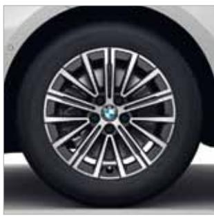
■ 17" M kola z lehké slitiny Double-spoke 834 M Bicolour Dark Grey, lesklá, rozměr kol 7 J x 17 s pneumatikami 205/60 R17.<sup>2</sup>
