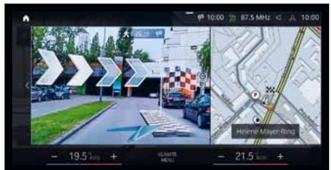
□ Rozšířená realita usnadňuje navigaci, když na kontrolním displeji zobrazuje živý obraz z perspektivy řidiče. Ten doplňuje dodatečnými informacemi o navádění, parkování a bodech zájmu. Symboly umístěné přímo v živém obrazu Vám například jasně ukáží, kam odbočit nebo kde zaparkovat.
