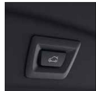
■ Automatické ovládání víka zavazadlového prostoru umožňuje pohodlné otevírání a zavírání víka zavazadlového prostoru jednoduchým stisknutím tlačítka umístěného v panelu dveří řidiče nebo na klíčku od vozu.
