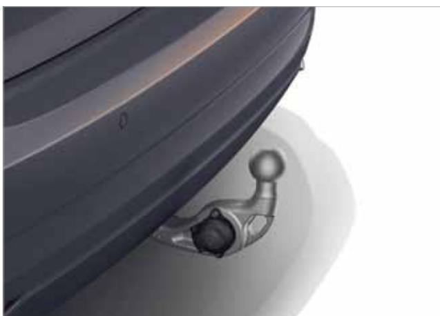
□ Tažné zařízení s elektricky výsuvnou kulovou hlavicí. Funkce stabilizace přívěsu a zabezpečení proti krádeži zvyšují bezpečnost.
