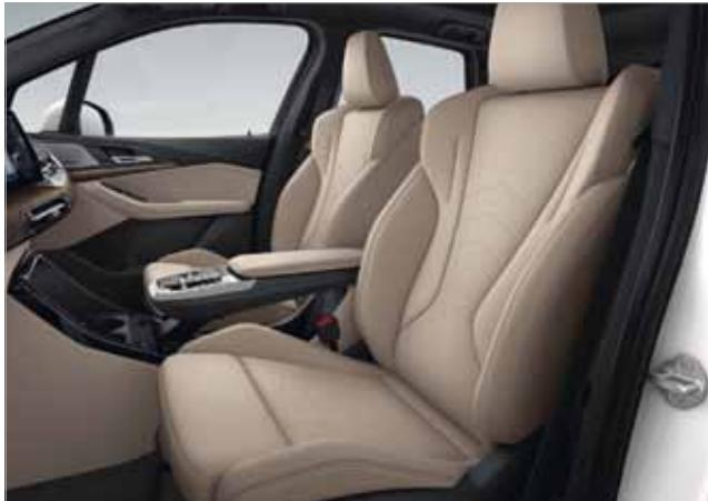
□ Aktivní přední sedadla – nastavitelný sklon sedáku a bederní opěrky pro optimální komfort sezení. Masážní funkce mobilizuje dolní část páteře, což minimalizuje známky únavy při sezení.
