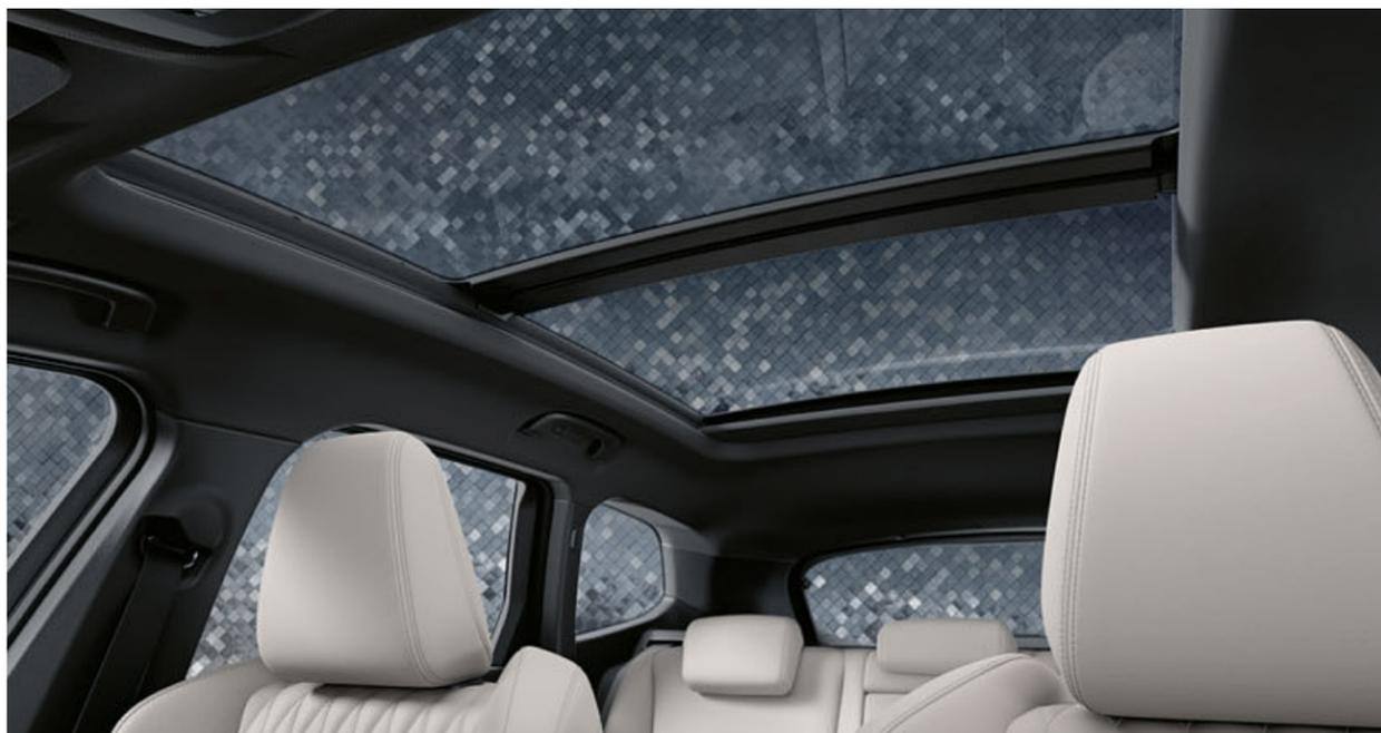
Pokud je součástí výbavy M antracitové čalounění stropu, je antracitová látka kromě stropu použita také na obložení A-sloupků. Tuto výbavu doplňují v černé barvě provedené následující detaily: černé horní části B- a C-sloupků, sluneční clony, stropní madla a obložení mikrofonu.
