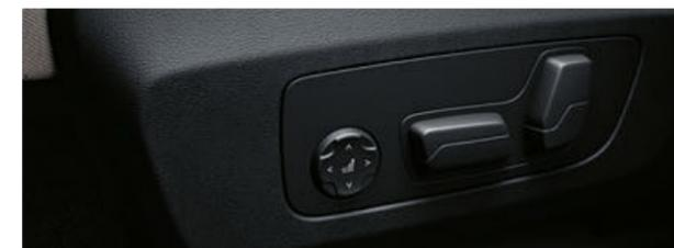
Elektrické nastavování zajistí snadné a pohodlné nalezení vhodné polohy předních sedadel. Nastavit lze výšku a sklon sedáku, podélnou polohu a úhel sklonu opěradla. Paměťová funkce umožňuje řidiči uložit nastavení sedadla řidiče a vnějších zpětných zrcátek do paměti.
