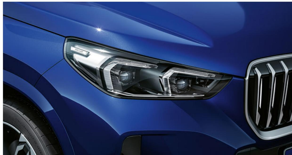
Adaptivní LED světlomety s matrixovou technologií se automaticky přizpůsobují podmínkám, ať už na dálnicích, nebo na okresních silnicích. Lépe vidíte i za špatného počasí. Pro maximální výhled: Světlomety detekují protijedoucí vozidla i vozidla jedoucí stejným směrem a pro zabránění jejich oslnění automaticky vypnou příslušné segmenty dálkových světel.
