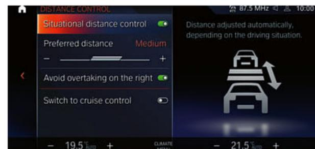
Driving Assistant Plus<sup>1</sup> přináší klidnější cestování. Zejména na delších cestách vám usnadní řízení tím, že automaticky udržuje požadovanou rychlost, jízdní pruh a vzdálenost od vozidla jedoucího vpředu, v případě potřeby začne automaticky brzdit. Upozorňuje také na rychlostní limity nebo značky zákazu předjíždění.
